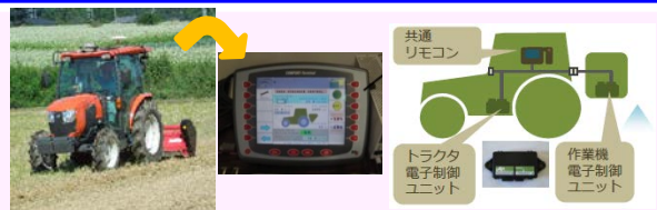
1-(2)トラクタの直進運転アシストとAG-PORT(農業機械通信インターフェース)による施肥量制御作業
