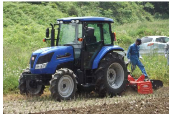
図2 パワーハローによる砕土
