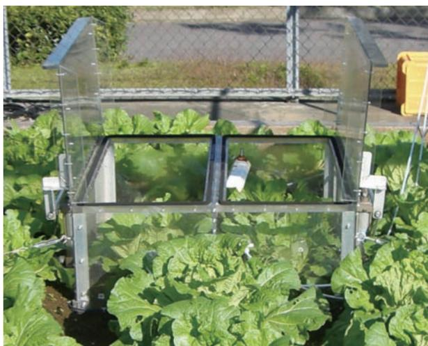
写真1 農耕地からの温室効果ガス発生量の自動連続測定装置
