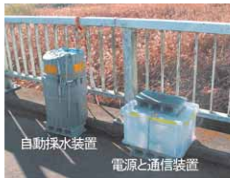
図 2 自動採水装置を用いた水質モニタリング(IV・3)
