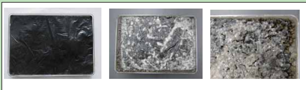
図6 培養土への酵素処理による生ブラフィルム(PBSA)の分解 (左: 無処理10日後 中: 処理6日後 右: 処理10日後)
