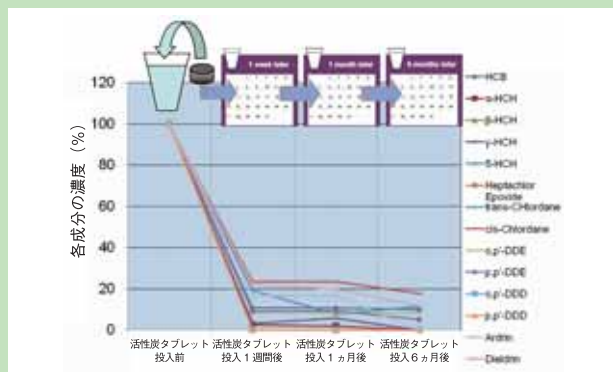
図2 微粉末活性炭タブレットによる14種の残留性有機汚染物質（POPs）の吸着性保持
