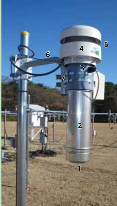
図8 NIAES-09型強制通風筒の外観と構造
