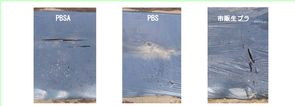
図1 施設圃場内に設置した生プラマルチの分解（培養ろ液のみ処理7日後） 酵素のみを散布した各種生プラマルチの分解の様子。
