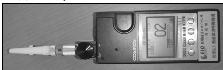
写真1 畜環研式ニオイセンサ（新コスモス電機株式会社 XP-329ⅢR）
