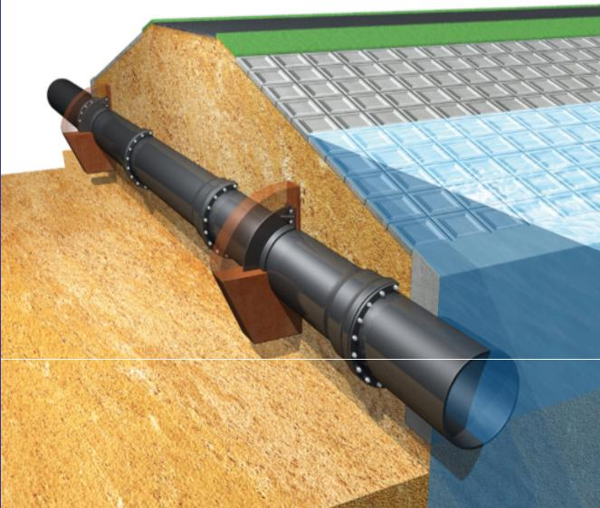
柔構造底樋の概要図
