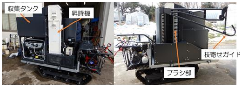
自走式・花蕾採取機 (試作1号機)
