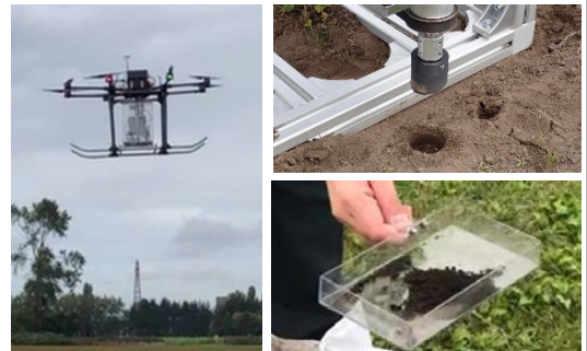
図2 圃場上空を移動するドローンおよび土壌サンプリングの結果
