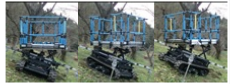
全ての方向で荷台水平制御可能
