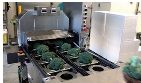
新たに開発したフローレットカッター 2連の連続式で受け皿の交換により大花蕾でも使用が可能
