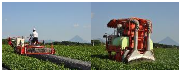
大規模茶生産に向けた被覆資材巻取機とサイクロン装置
