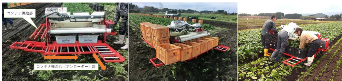
図3 加工野菜収穫機（ニシザワ MNSH-1300）と開発した連続収穫のための「小型コンテナ横流れユニット」
