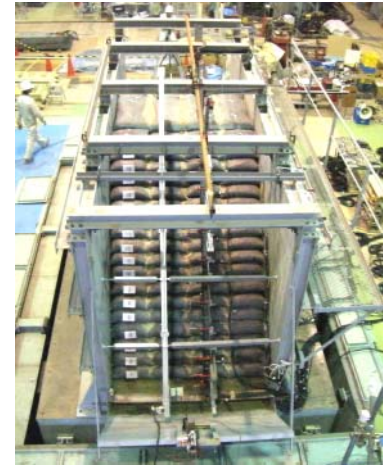
実物大の耐震実験の模型
