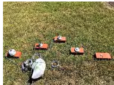
写真1 日射計性能比較試験の様子
