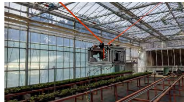
写真2 環境計測用温室内移動ロボット
