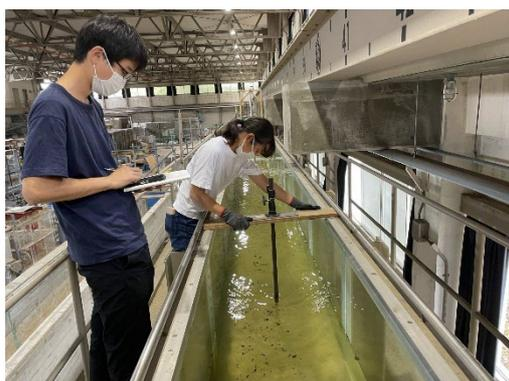
水理模型実験での水面形の計測
