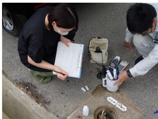
携帯型センサーによる地下水サンプルの水質測定結果を記録
