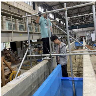
水利模型実験でのゲート開度操作
