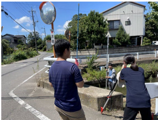
排水路横断測量
