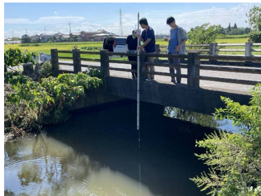
排水路流量観測
