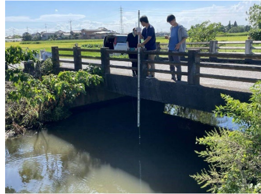
排水路流量観測
