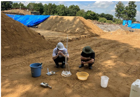
負圧浸入計による現場透水試験
