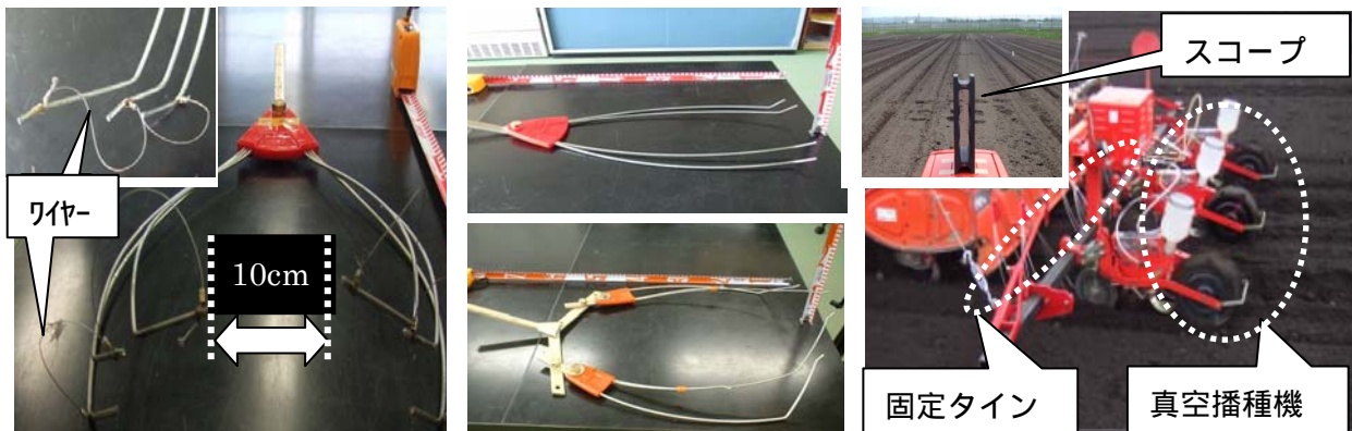
図3 固定タイヤとスコープ等(左: 改良型Hレーキ(10cm開)、上: Vレーキ、下: Cレーキ、右: スコープと真空播種機)
