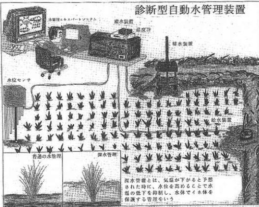
図1 水田内に装置した診断型自動水管理装置
