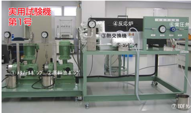
超臨界法バイオディーゼル変換装置
