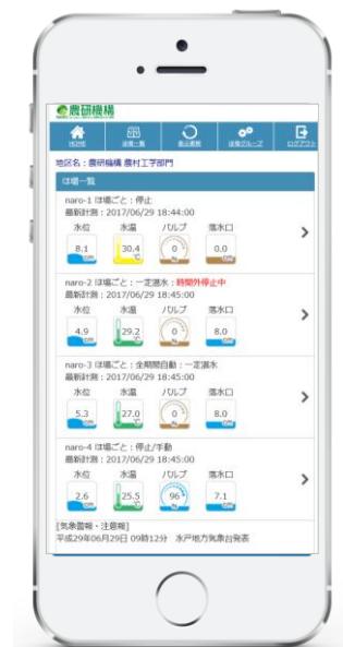
図2 スマートフォン上の水管理アプリの操作画面
