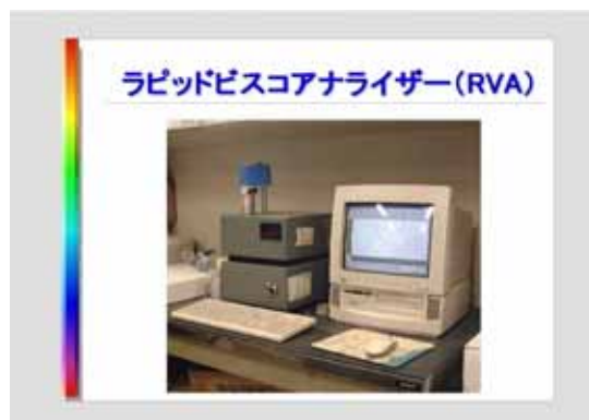
図 1 . 従来の糊化特性測定装置 (ラピッドビスコアナライザー、RVA)
