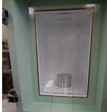
認証値の付与のための放射能測定に用いた外径 110 mm のゲルマニウム半導体検出器
