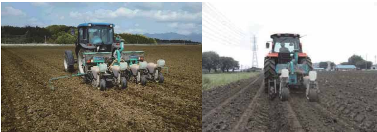
写真19. ソルゴーアタッチを取り付けた4条用（左）および2条用（右）のコーンプランタでのトウモロコシ・ソルガム混播の播種作業.
