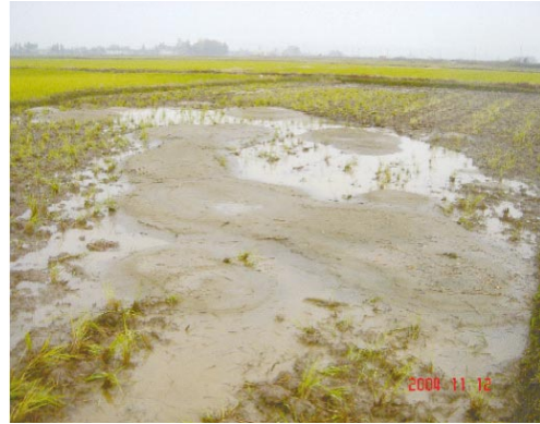
Fig.11 水田における噴砂 Sand blow in paddy field
