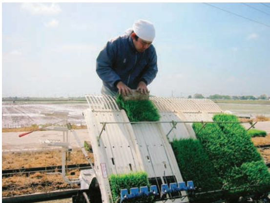
図2 水稻の種子付きマットから育成した苗マットを田植機へセットする状況
