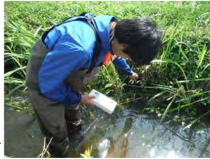
図2-22 流速計を用いた測定（細川晴華撮影）→
