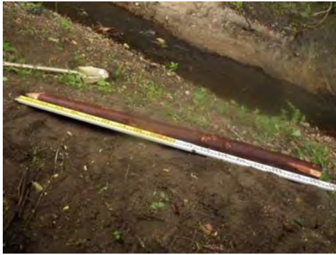
図 4-26 試験杭の完成 (φ10cm、L=1.8m)
