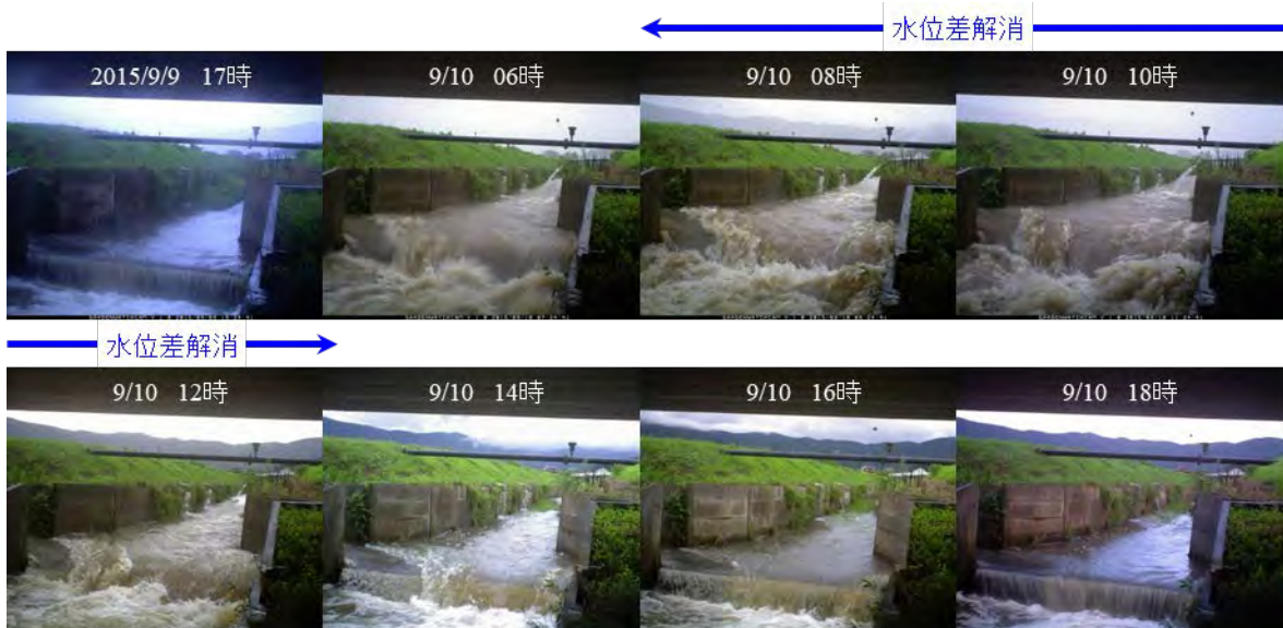
図3-7 タイムラプスカメラが捉えた落差工における降雨時の水位変動
