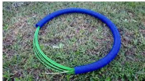
写真8 プラチェーン挿入に用いた通線ワイヤー
