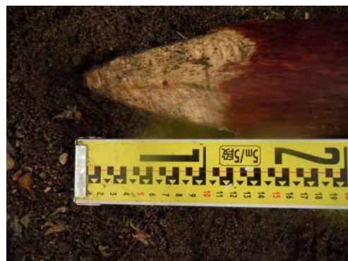
図 4-25 試験杭の作成
