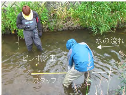
図2-20 ピンポン玉を用いた流速測定（左：渡部撮影、右：細川晴華撮影） ※調査者やスタッフが水の流れを遮らないように注意する。
