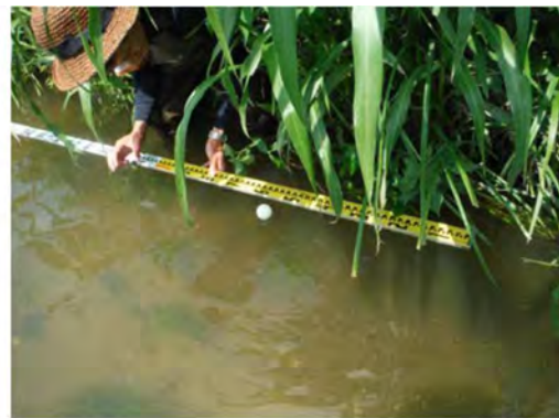
図2-20 ピンポン玉を用いた流速測定（左：渡部撮影、右：細川晴華撮影） ※調査者やスタッフが水の流れを遮らないように注意する。
