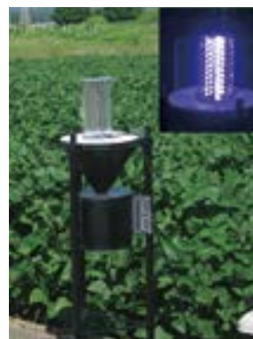
写真2 開発したLEDトラップ（右上点灯時）
