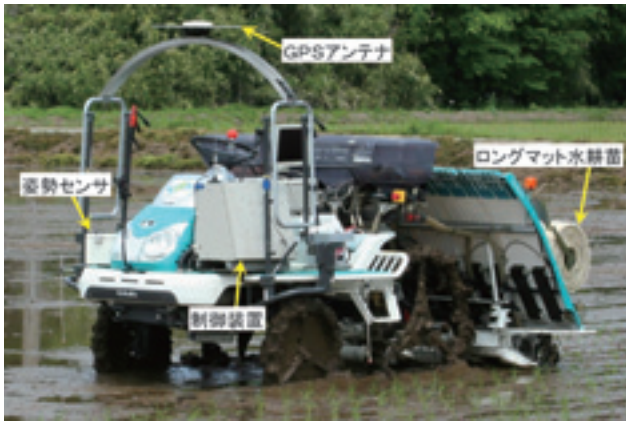
図1 開発した田植えロボット
