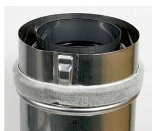
モヘアシール(15mm幅)を、二重管のストッパー金具の直下、段の上端に沿つて1周するように張り付ける。
