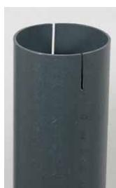
樹脂用のこぎり(または切断砥石を装着したリューター)を使って、塩ビ管に幅1mm弱、長さ17mmの切れ込みを長さ方向に入れる。切れ込みの位置は、センサーの中心が塩ビ管の中心に来るよう、巻末の位置合わせ用の図を使ってセンサーの太さに合わせて決める。HOBO U23-002を使用する場合は塩ビ管の中心を横断する線を4mmずらした位置とする。
