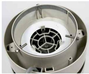
換気扇に付属しているダクト取付板を換気扇の吸気口に両面テープで固定する(脱落防止)。ホットボンドが使えるなら、ダクト取付板を所定の位置に入れてから、3本ある爪と板との角にホットボンドを垂らして固定するとよい。
