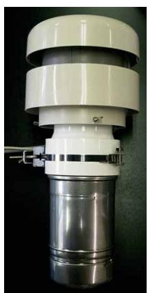
継手の細い側に換気扇を載せ、換気扇に備え付けられた3つのネジを均等に手で締める。換気扇がぐらつかず、容易に外れない程度でよい。締め過ぎると換気扇や継手が変形するので注意する。
