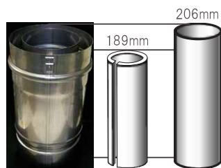
塩ビ管をステンレス二重管の内筒と同じ長さ(206mm)に、パイプカバーはそれより17mm 短い189mmに切る。
