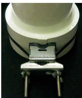
フェンス用マスト固定金具のバンドを塩ビ管用継手の太い方に巻き締める。
