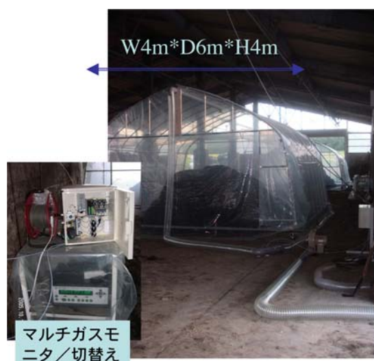
写真 2：堆肥化時の温室効果ガス測定試験装置（約 10m 3 のふん尿混合物を評価できる）
