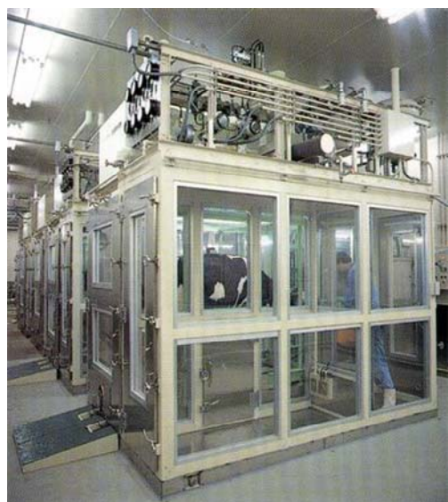
写真1：開放式呼吸試験装置(牛用、家畜の発生メタン等を精密測定する)
