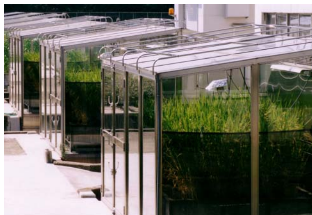
図2 大型の自然光型人工気象室, クライマトン(茨城県つくば市農業環境技術研究所)における実験風景
