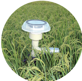
観測ネットワークで使用する 自立型気象観測装置「MINCER」
