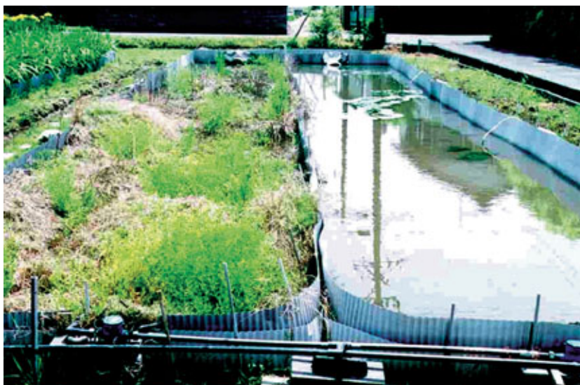
写真1 休耕田の掛け流し灌漑による硝酸性窒素除去試験
