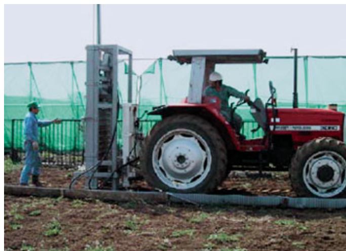
図1 トラクター3点リンクへの不攪乱大型土壌コア採取装置の接続
