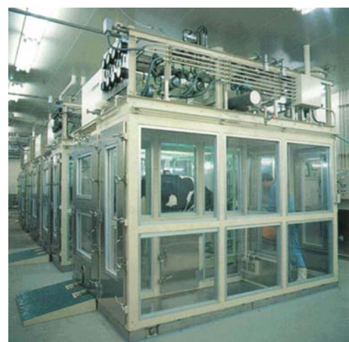
図6. 高温・高湿度による牛の摂食量・飼料消化率・飼料効率や肉質に及ぼす影響を調べる実験 温度・湿度を制御できる人工気象室内で牛を飼養して畜肉の生産性を調べます。
