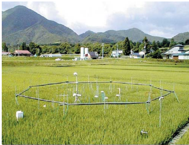
図5. 岩手県雫石町の農家水田における開放系大気 CO 2 増加 (FACE) 実験
