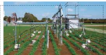
農耕地土壌の有機物分解に及ぼす温暖化影響を調べる野外加温操作実験(小麦が少し大きくなった3月頃。白い物体は土壌からのCO 2 の放出を測定するチャンパー)
