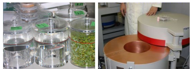
調査前の試料(左)とゲルマニウム半導体検出器(右) (検出器本体は、厚い鉛の中に格納されています)
