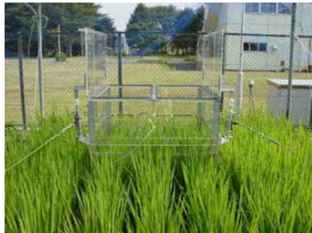
図1 \text{CH}_4 ・ \text{N}_2\text{O} フラックス自動連続測定システム
