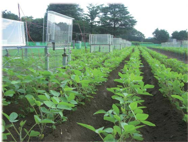
写真3 根粒菌を接種したダイズほ場およびN 2 O発生量モニタリング装置
