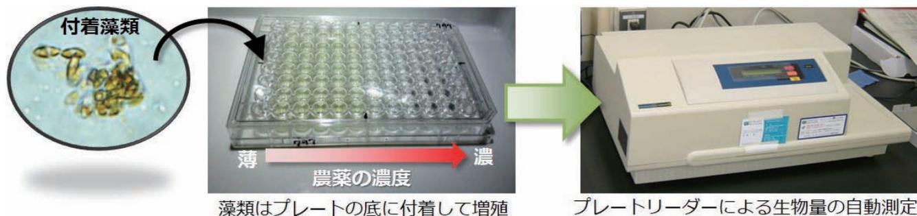
**図2 マイクロプレートを用いた付着藻類の試験法**
