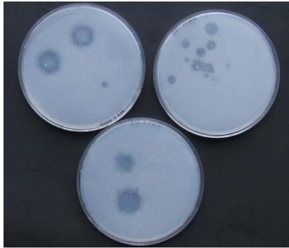
図 1. 生プラ分解菌の選抜 透明な部分には生プラを分解するカビが生育しています。
