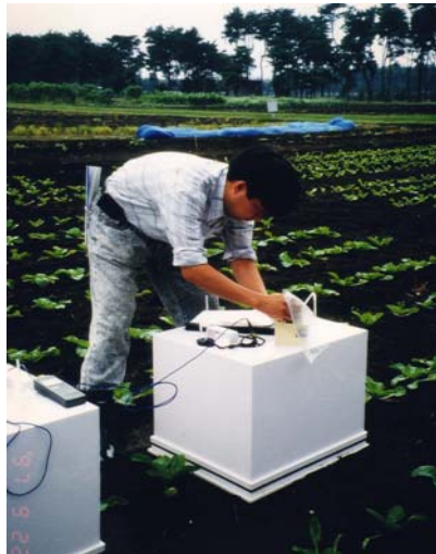
写真 1: 手動のサンプリング風景 ・これまで主流だった手動のサンプリング法では、チャンバーの設置やガスのサンプリングなど一連の作業をすべて人力で行うため、多大な労力がかかっていました。
