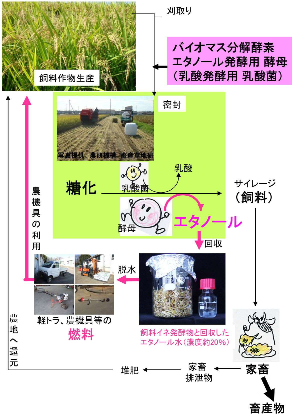
図1 農業地域資源循環過程で自給エネルギーと飼料を生産する固体発酵法
