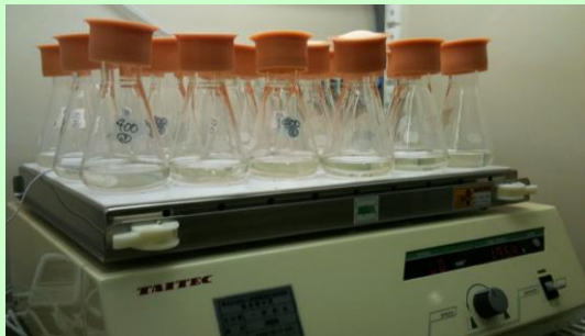
図 1 三角フラスコを用いた試験法を、マイクロプレートを用いた試験法に改変 藻類がフラスコ壁面に付着するため、付着藻類への適用が困難だったのに対して、 新試験法では、マイクロプレート底面に付着させた状態で生物量の測定を行います。
