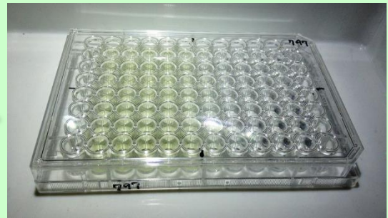
図 1 三角フラスコを用いた試験法を、マイクロプレートを用いた試験法に改変 藻類がフラスコ壁面に付着するため、付着藻類への適用が困難だったのに対して、 新試験法では、マイクロプレート底面に付着させた状態で生物量の測定を行います。
