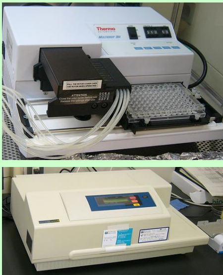
図 2 分注・測定自動化 試験の小型化によって、培養液等の分注（上） や測定（下）の自動化が可能となりました。
