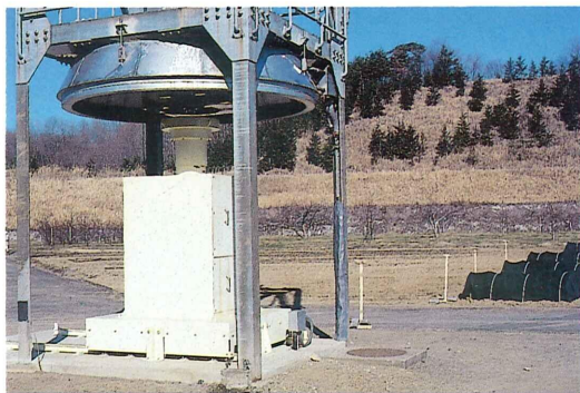
第1図 照射塔の下に設置した新遮蔽体
