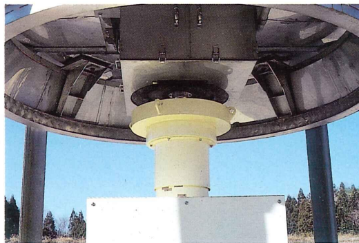
第2図 ^{60}\text{Co} 線源直下に設置した遮蔽体の本体
