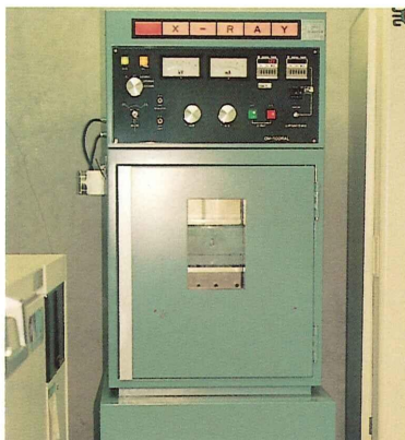
第1図 小型の軟 X 線照射装置 Fig. 1 A compact soft X-ray apparatus.
